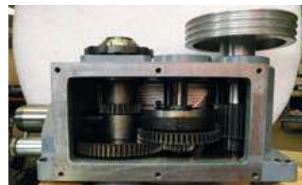
Scatola ingranaggi in bagno d'olio.
