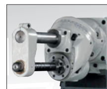
· Lavorazioni in posizione di fresatura orizzontale, con supporto albero portafrese (MT 100)
