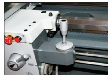
Avanzamento rapido per lavorazioni veloci · Pulsante e leva di selezione per l'attivazione della marcia rapida per direzione trasversale e longitudinale
