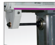
· Lavorazioni in posizione di fresatura orizzontale, con supporto albero portafrese (MT 200)
